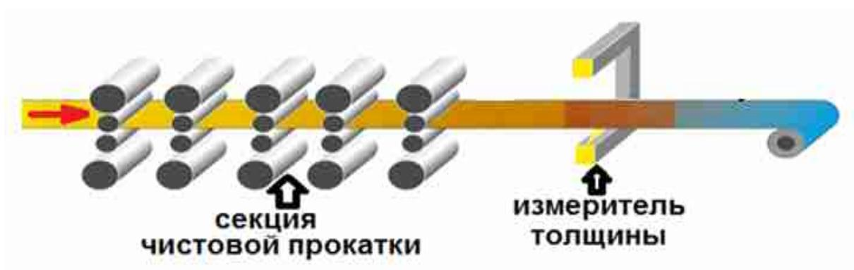
Рис. 4.20. Схема расположения измерителя на прокатном стане.
