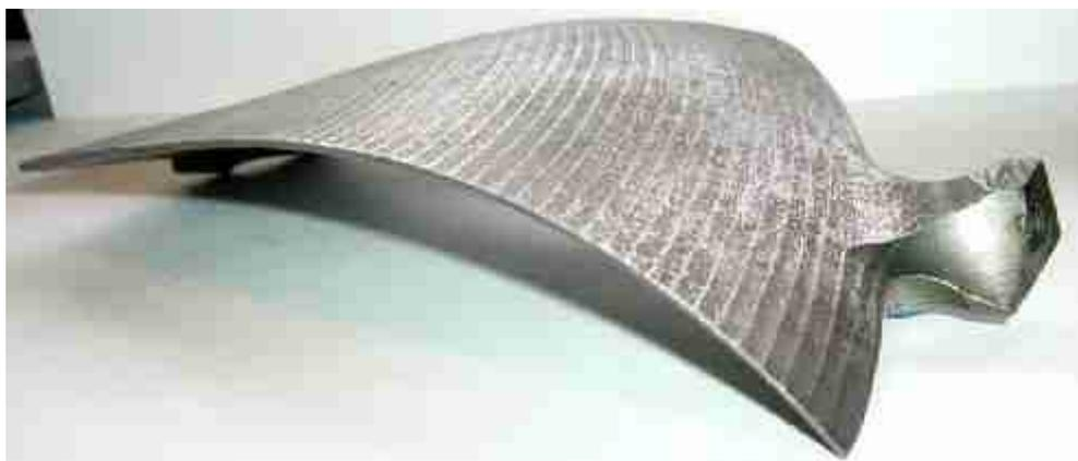
Рис. 4.4. Модель лопатки гидротурбины с характерными размерами 150x120x80 мм.
