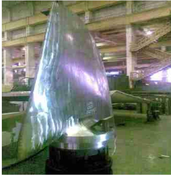
Рис. 4.14. Лопать рабочего колеса лопатно-поворотной турбины Святогорской ГЭС (проба №33781) (вид сбоку).
