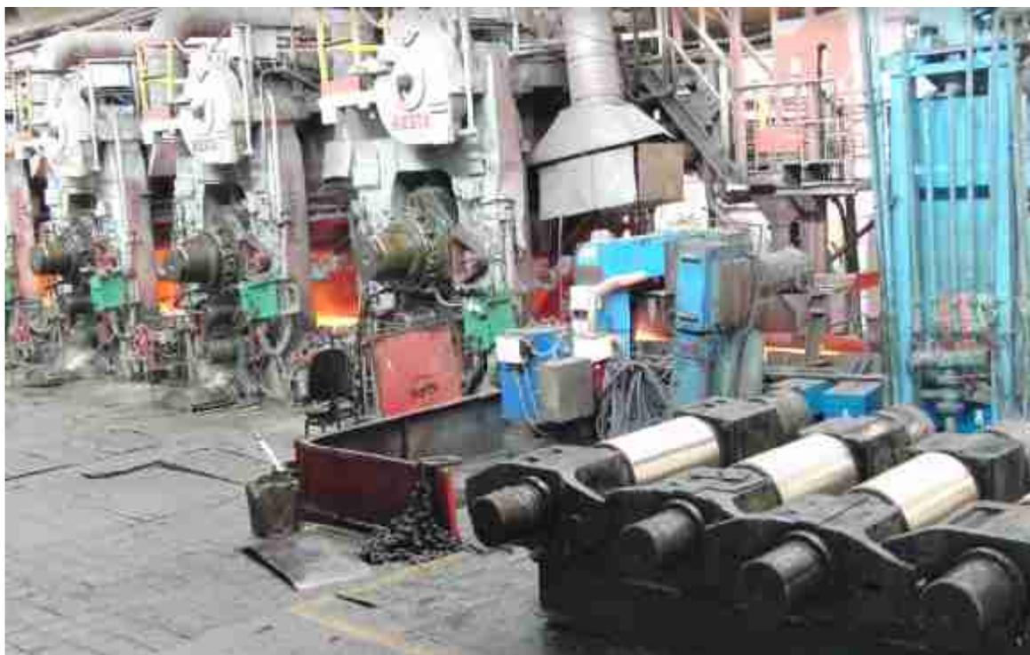
Рис. 4.19. Размещение измерительного комплекса для измерения толщины горячего проката в цехе горячего проката на прокатном стане ОАО «НМЗ им. Кузьмина».
