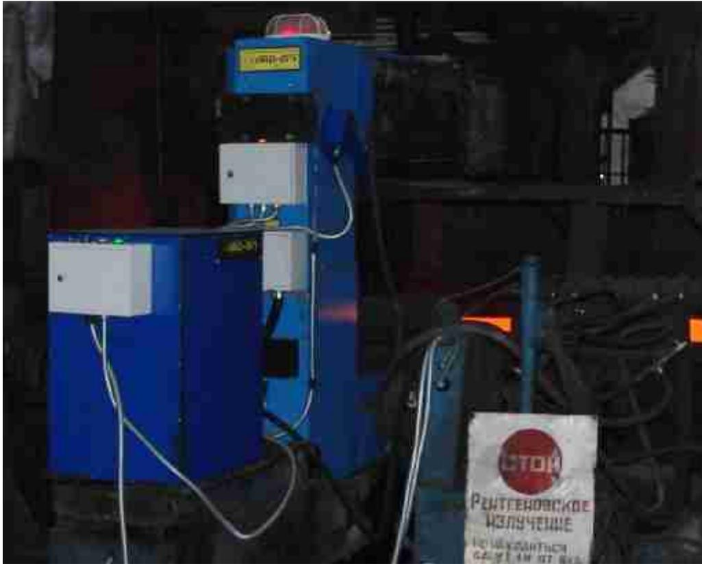
Рис. 4.21. Экспериментальный образец лазерного толщиномера горячего проката на прокатном стане ОАО «НМЗ им. Кузмина» во время проведения промышленных испытаний.
