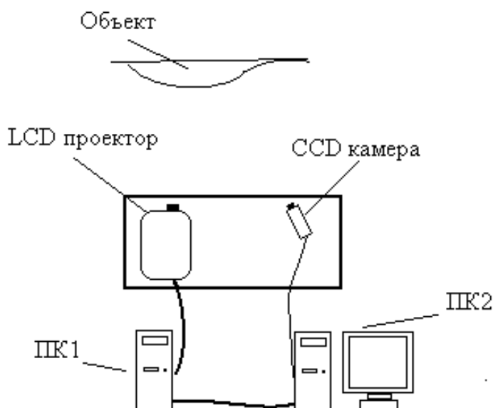
Рис.3.1. Схема прототипа оптоэлектронной координатно-измерительной системы.
