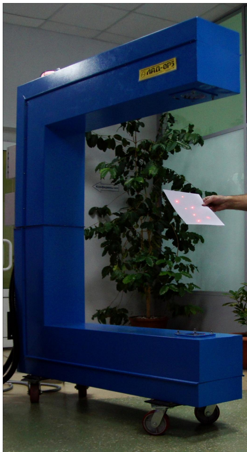
Рис. 3.22. Внешний вид макета измерителя толщины горячего проката перед отправкой на испытания.
