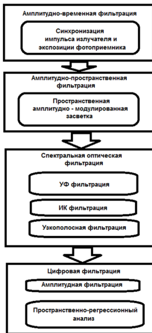
Рис. 3.38. Фильтрация сигналов в облачном триангуляторе.
