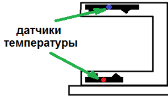
Рис.3.69. Расположение датчиков температуры в измерительном комплексе.
