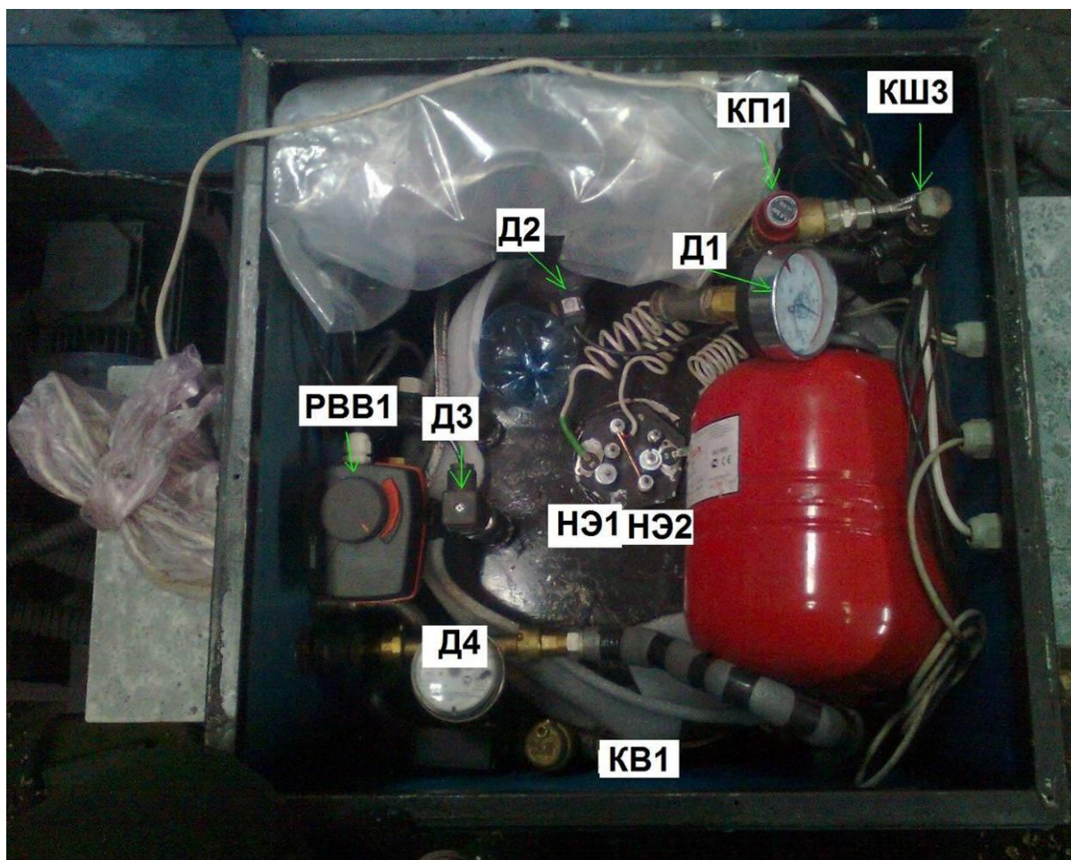
Рис. 3.63. Основные узлы термостата.
