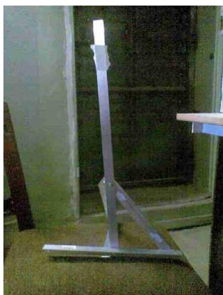
Рис. 2.21. Опорная калибровочная цель, используемая в процедуре калибровки.
