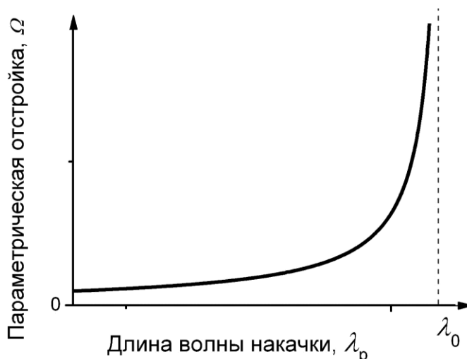
Рис. 1.8. Качественная зависимость частоты параметрической отстройки векторного ЧВС \Omega_v от длины волны накачки \lambda_p .
