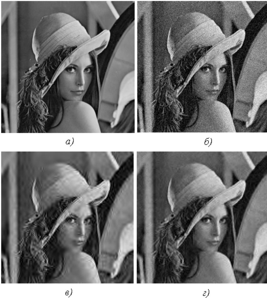
Рис. 5. Представлены изображения: точное (а); искаженное шумом (б); полученное в результате фильтрации с порогом  $\lambda_j^{UNIV}$  (в) и с порогом  $\lambda_j^W$  (г)
