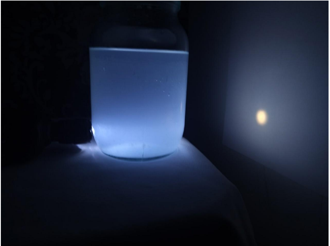
Рис 2 Демонстрация рассеяния света в среде с рассеивающими частицами
