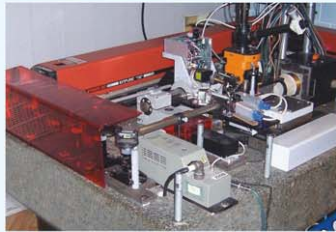
Упрощенная схема и фотография круговой лазерной записывающей системы CLWS-300IAE, разработанной в ИАиЭ СО РАН
