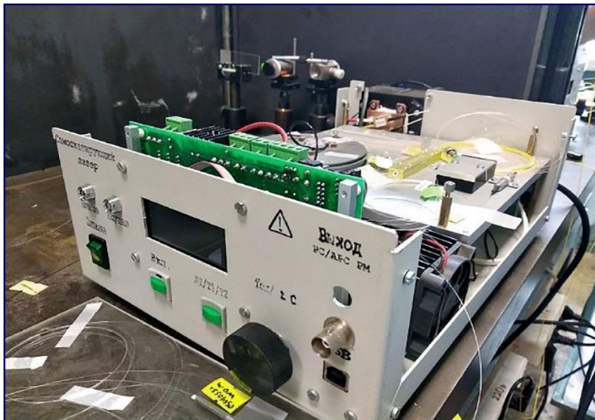
Рис. 4.2. Макетный образец распределенной сенсорной системы с субмиллиметровым пространственным разрешением
