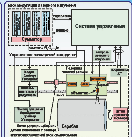
Функциональная схема устройства ROMB-Vis" – растрового типа с механизмом развертки на основе вращающегося внешнего цилиндра и 16-лучевой оптической схемой записи.
