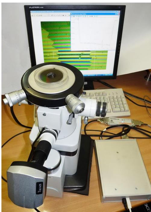
Оптический профилометр на основе микроинтерферометра МИИ-4М
