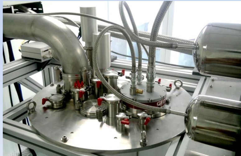
Охладитель пульсирующей трубки (pulse tube cooler)
