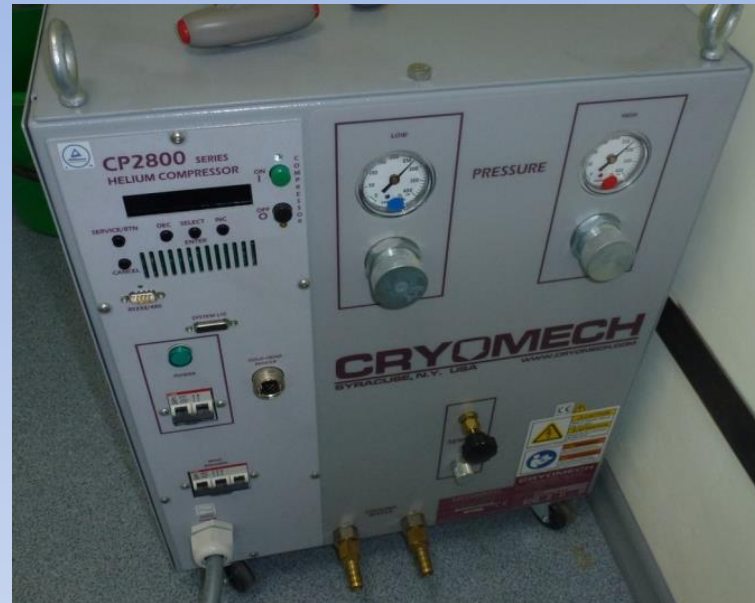
Мощный компрессор для механического охлаждения газа He_4
