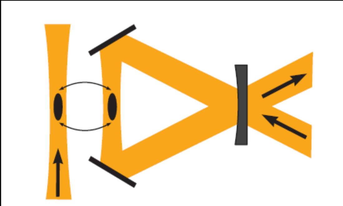
Атомы в перетяжке моды кольцевого резонатора
