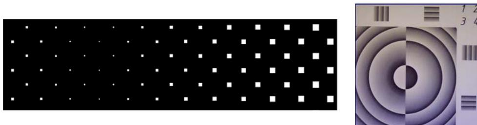
**Рис. 2.17.** *a* – фрагмент структуры бинарно-амплитудной голограммы нулевого порядка на периферийном участке; *б* – фрагмент полутонового изображения решетки с пилообразным профилем штрихов и с периодом 100 мкм
