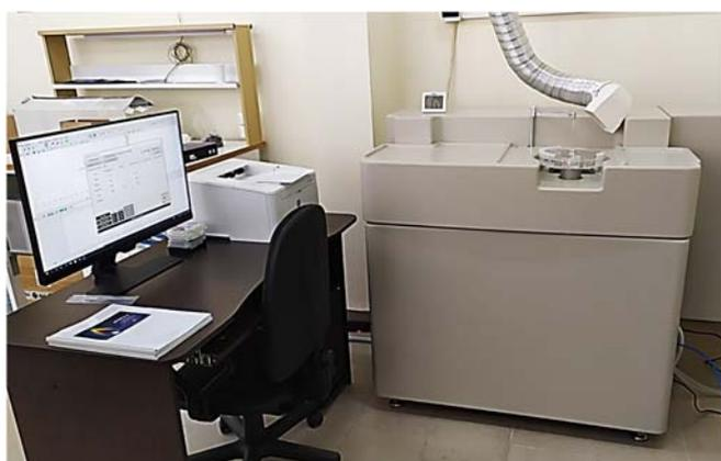
**Рис. 4.1.** Атомно-абсорбционный спектрометр Гранд-ААС
