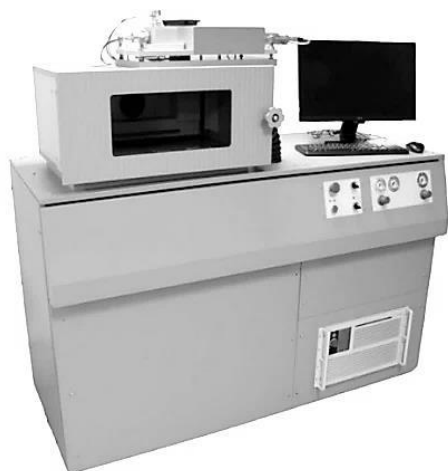
Рис. 2.21. Модули комбинированной лазерной системы: a – 3D-принтера с 500 Вт лазером; б – фемтосекундной 3D-обработки
