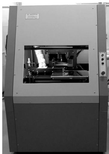
Лазерная технологическая рабочая станция на основе пикосекундного лазера (ЛРС-П) предназначена для лазерной микрообработки изделий из металла, керамики, кристаллических материалов путем лазерной трехмерной послойной обработки поверхности, резки, ЛРС-П обеспечивает высокую точность и разрешение, возможность обработки металлических материалов с малой шероховатостью.
