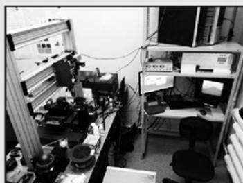
Лабораторный макет установки по записи ВБР с помощью фемтосекундного лазера
