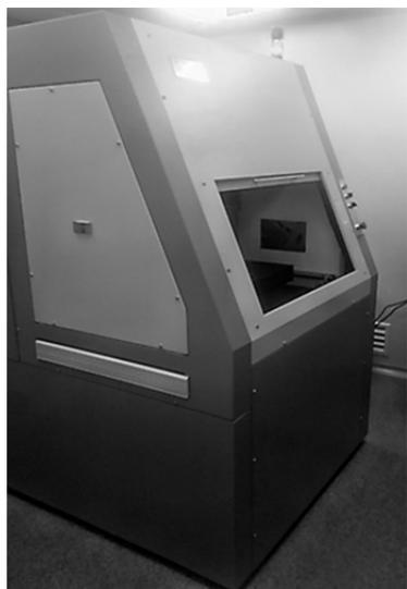
Лазерная технологическая рабочая станция на основе фемтосекундного лазера (ЛРС-Ф) предназначена для микрообработки изделий из металла, керамики, кристаллических материалов и оптического стекла путем трехмерной послойной обработки поверхности, резки и регулируемой объемной оптической модификации прозрачных материалов. ЛРС-Ф обеспечивает высокую точность и разрешение, возможность обработки хрупких материалов без микротрещин и сколов методами прямой лазерной обработки.
