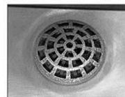
Металлическая модель. Высота 7 мм (140 слоев)
