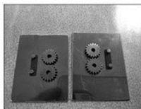
Металлическая модель. Высота 5 мм (100 слоев)
