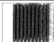
Тест формы и разрешения. Высота 5 мм (100 слоев)
