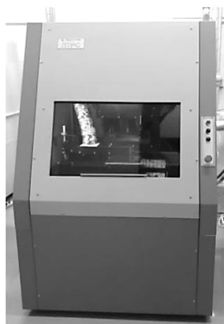
**Рис. 2.33.** Внешний вид системы микрообработки на основе пикосекундного лазера Atlantic 1064–20 и комплементарной системы сканирования
