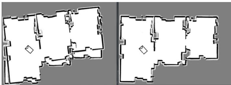
**Рис. 2.53.** Карты препятствий виртуального окружения: без замыкания циклов (слева) и с использованием техники замыкания циклов (справа)
