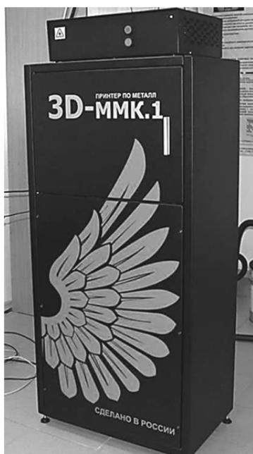
**Рис. 5.1.** Лазерная система для аддитивного изготовления металлических моделей методом селективного лазерного сплавления мелкодисперсных металлических порошков
