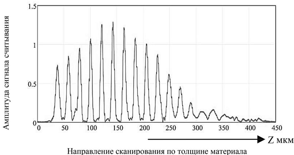
**Рис. 2.22.** Зависимость огибающей сигнала детектирования последовательности микрорешеток от глубины их размещения
