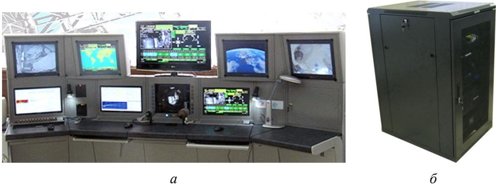
**Рис. 1.7.** Внешний вид системы отображения и регистрации многоканальной информации: *a* – пульт контроля и управления тренажёром, *б* – вычислительный блок системы
