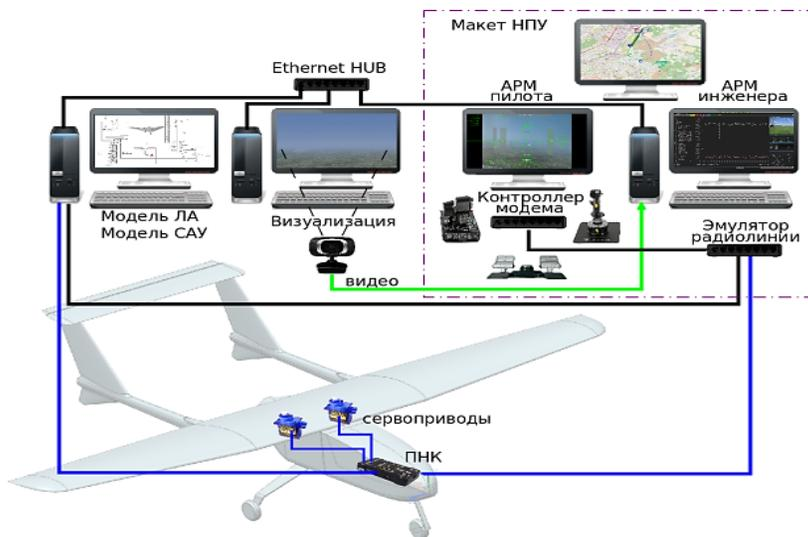
**Рис. 2.46.** Структурная схема комплекса полунатурного моделирования (синим цветом выделены линии связи, задействованные при программно-аппаратном тестировании, зеленым – видеоканал макета носовой камеры самолета)
