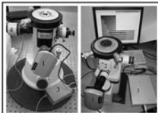
Варианты модернизации МИИ-4 (а) и МИИ-4М (б): 1 – USB-видеокамера; 2 – блок датчика перемещений; 3 – USB-контроллер; 4 – светодиодный осветитель без волоконного подвода светового пучка
