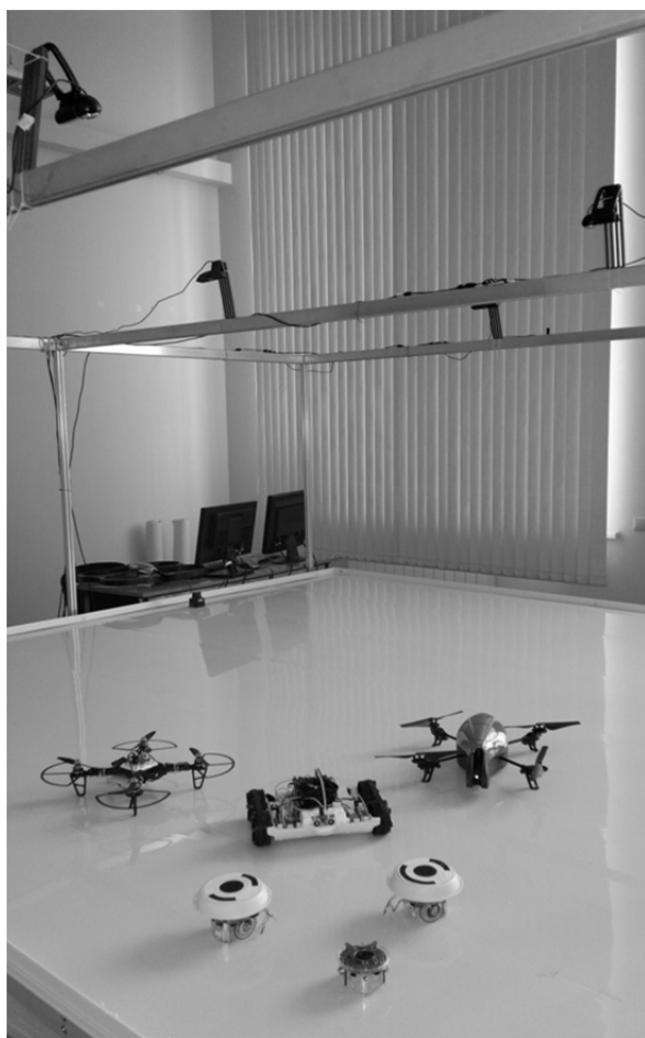
Рис. 4.1. Стенд для тестирования и отладки систем управления и навигации автономными мобильными платформами
