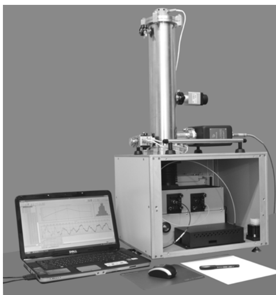
Рис. 6.5. Внешний вид гравиметра со снятой передней крышкой (для демонстрации компоновки)
