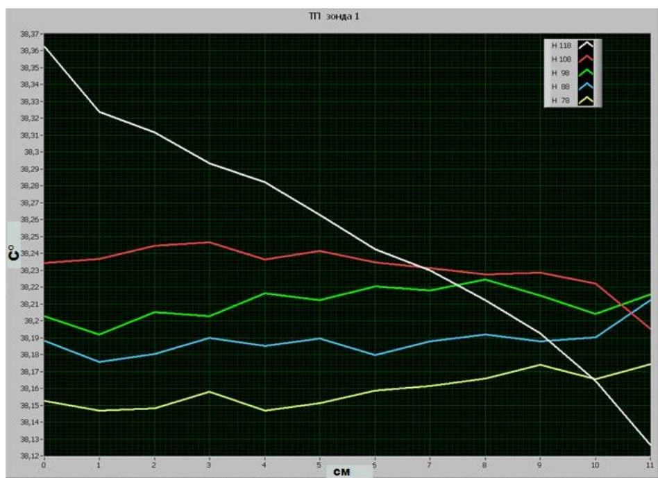
Рис. 2.44. Распределение температур в тигле при ступенчатом разогреве его поверхности.
