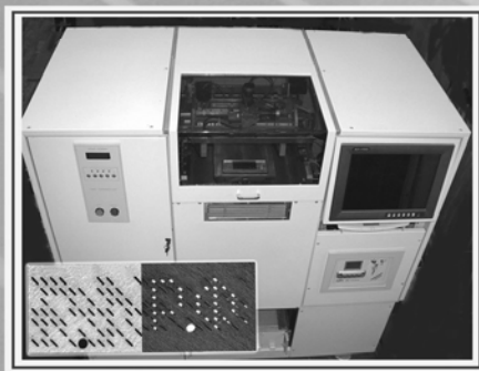
Лазер СО, 250 Вт, разрешение 5 мкм, поле записи 200x300 мм, Z–150 мм
