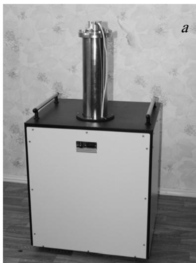
Рис. 2.11. Полевой лазерный гравиметр «ГАБЛ-Мини» в собранном виде (а) и со снятыми крышками (б)
