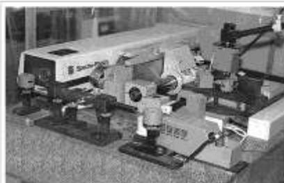
Круговая лазерная записывающая система ИАиЭ: шаг записи 300 мкм, размер записываемого пятна 0,5 мм
