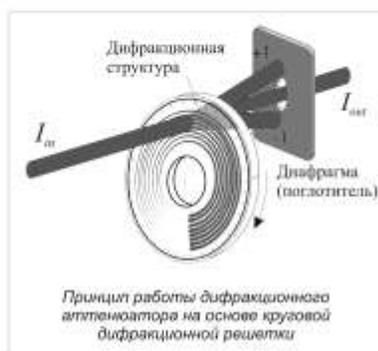
Принцип работы дифракционного аттенуатора на основе круговой дифракционной решетки
