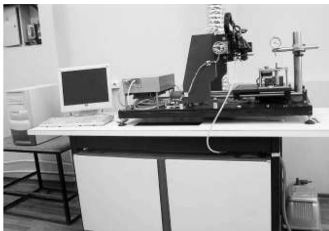
**Рис. 2.1.** Лазерный комплекс пятикоординатной микрообработки
