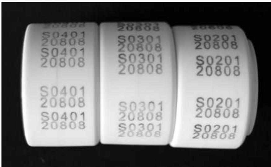
**Рис. 6.1.** Образцы изоляторов из керамики ВК95 с выполненной маркировкой
