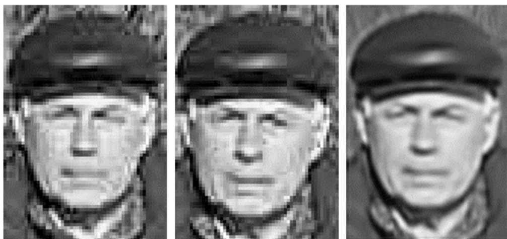
Рис. 2.8. Формирование изображения повышенного разрешения из последовательности изображений фрагмента фона – трехкратно увеличенные фрагменты: 1-го и 25-го изображений ( a, б ), изображения повышенного разрешения ( в )
