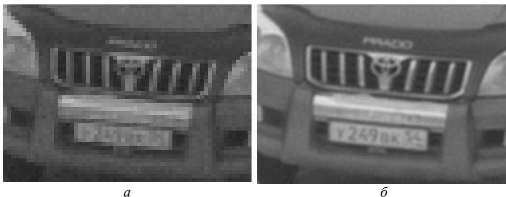
Рис. 1.4. Повышение разрешения: а – одно из исходных изображений низкого разрешения, б – изображение с трехкратно повышенным разрешением (по серии из 25 изображений)
