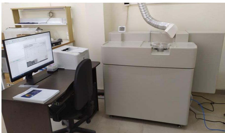
Рис. 1.8. Спектрометр Гранд-ААС в ЦКП Института общей и неорганической химии РАН, г. Москва
