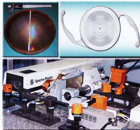
На фото: Синтезированная голограмма, бифокальная интраокулярная линза и круговая лазерная записывающая система CLWS-300IAE
