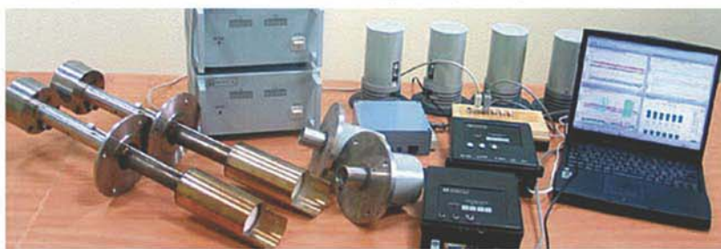
Многоспектральные (УФ, видимый, ИК) датчики и газоанализаторы системы
