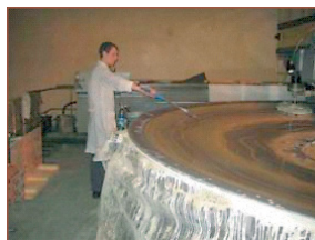
Телескоп VISTA и полировка зеркала в ЛЗОС
