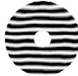
CGH #1. Контроль в ИК (10.6 \mu\text{m} ); ошибки 0.02 \lambda (rms).
