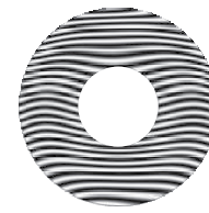
Линзовый компенсатор Было: RMS=0.212 \lambda Обнаружена ошибка сборки 0,2 мм Стало: 0.044 \lambda RMS
