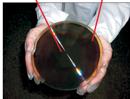
Голограмма для контроля 6,5-м зеркала.
