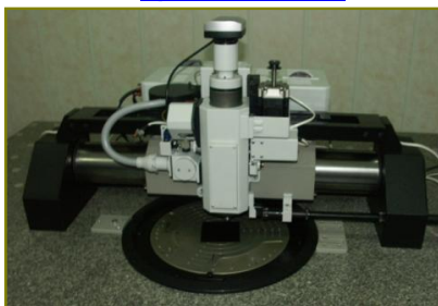
ЛГИ (фотоплоттер) на основе полупроводникового лазера
