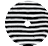
CGH#2. Контроль \lambda=633 nm; ошибки 0.027 \lambda (rms).
