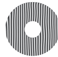
Зеркальный компенсатор Было: RMS=0.112 \lambda Обнаружена зональная ошибка Стало: 0.04 \lambda RMS
