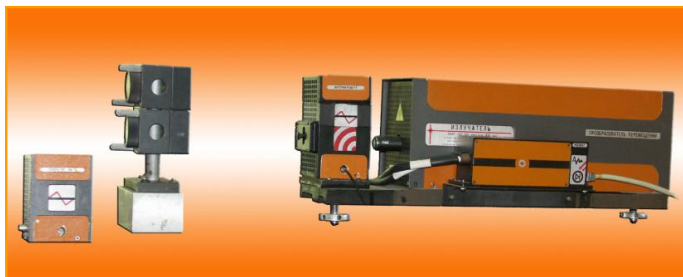
Семейство интерферометров первого поколения с внутренней фазовой модуляцией
