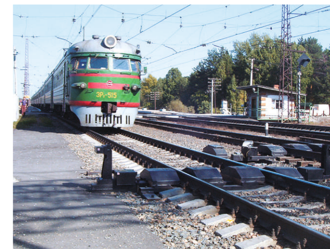
Лазерная диагностическая система «Комплекс» для бесконтактного контроля геометрии колесных пар на ходу поезда на станции Инская Западно-Сибирской железной дороги.
