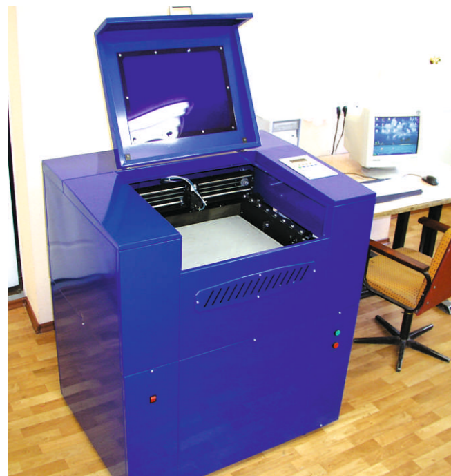
Рис. 9. Универсальный лазерный гравер. Поле записи 300×400 мм, шаг дискретизации 14 мкм, перемещение по Z = 150 мм с шагом 50 мкм. Лазер CO 2 30-50 Вт. Области применения: изготовление печатей, сувениров, шильдиков для радиоаппаратуры и т. д.
