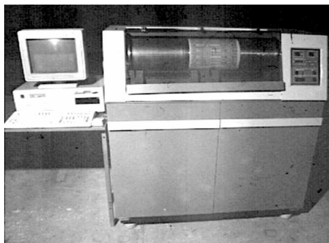
Рис. 7. Серия лазерных термографических имиджсеттеров "СО 2 РОМБ". Отличительные особенности: использование непрозражаемых бессеребрянных материалов, работа в незатемненном помещении, высокая точность ( \pm 25 мкм) и разрешение (12,5 мкм). Максимальные форматы носителей 520×600 или 660×840 мм.
