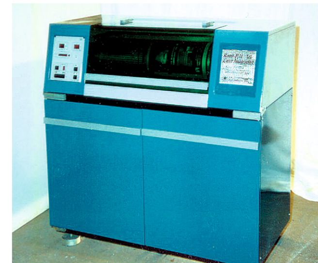
Рис. 8. Ромб Vis 1993 г. 16 лучевой лазерный фотопостроитель для полиграфии и производства фотооригиналов печатных плат. Шаг дискретизации 5-25 мкм, поле записи (в зависимости от модели) до 700×900 мм. Время вывода кадра 6 мин.
