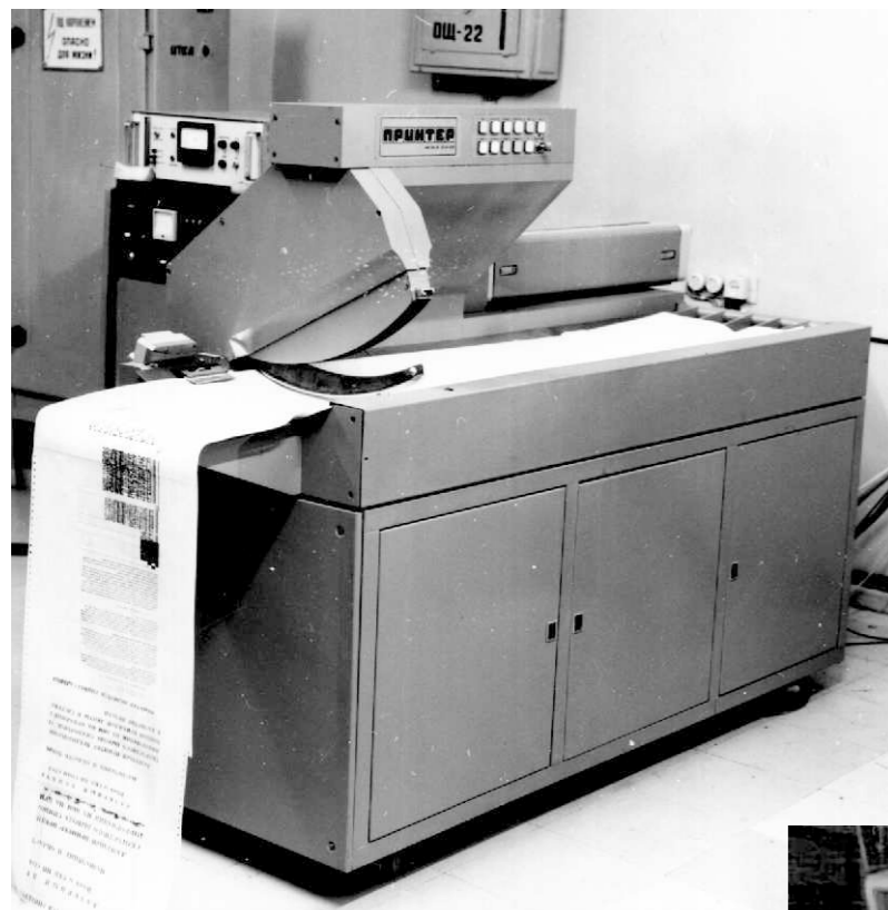
Рис. 5. Первый в СССР лазерный принтер. Технология лазерный термоперенос. Лазер 20 Вт ИАГ. Система сканирования с интерферометрическим контролем угла положения.
