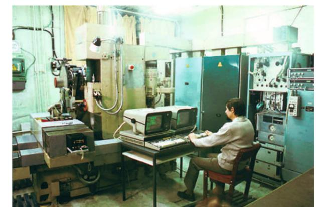
А. В. Астанков программирует числовой программный комплекс для фрезерно-расточного станка.
