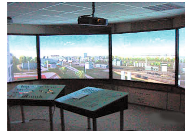
Общий вид ТГК. Панорамное изображение рабочей зоны оператора сформировано трехканальной компьютерной системой визуализации.
