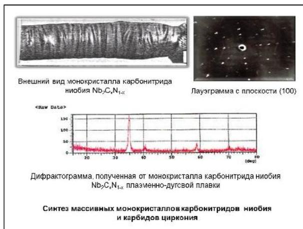
В Институте металлургии и материаловедения им. А.А. Байкова впервые синтезированы массивные карбонитриды ниобия и двойные карбонитриды ниобия и циркония монокристаллической структуры, которые могут служить основой создания функциональных материалов нового поколения для работы в экстремальных условиях. (ак. Солнцев К.А., чл.-к. Бурханов Г.С.)
