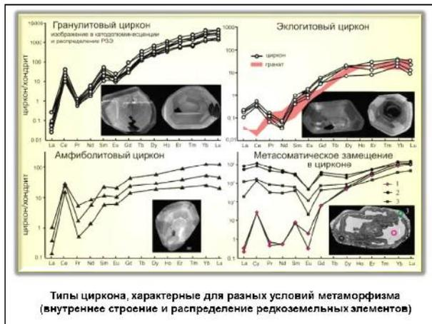
В Геологическом институте Кольского научного центра выявлены реперные типы циркона, характерные для гранулитовой, эклогитовой и амфиболитовой фаций метаморфизма. Выявленные закономерности представляют собой фундаментальную основу для корректной интерпретации данных по циркону при изотопной уран-свинцовой геохронологии. (ак. Митрофанов Ф.П., к.г.-м.н. Каулина Т.В., ГИ КНЦ РАН)
