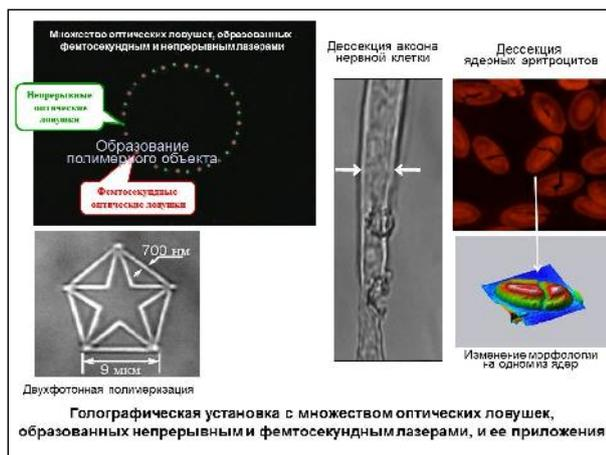
В Институте химической физики им. Н.Н. Семенова разработана голографическая установка с множеством оптических ловушек, образованных непрерывным и фемтосекундным лазерами. Каждая из них может одновременно с другими перемещаться по различным индивидуальным траекториям. Предложены новые подходы по использованию фемтосекундных импульсов для осуществления сложных микрохирургических операций. (д.ф.-м.н. Саркисов О.М.)
