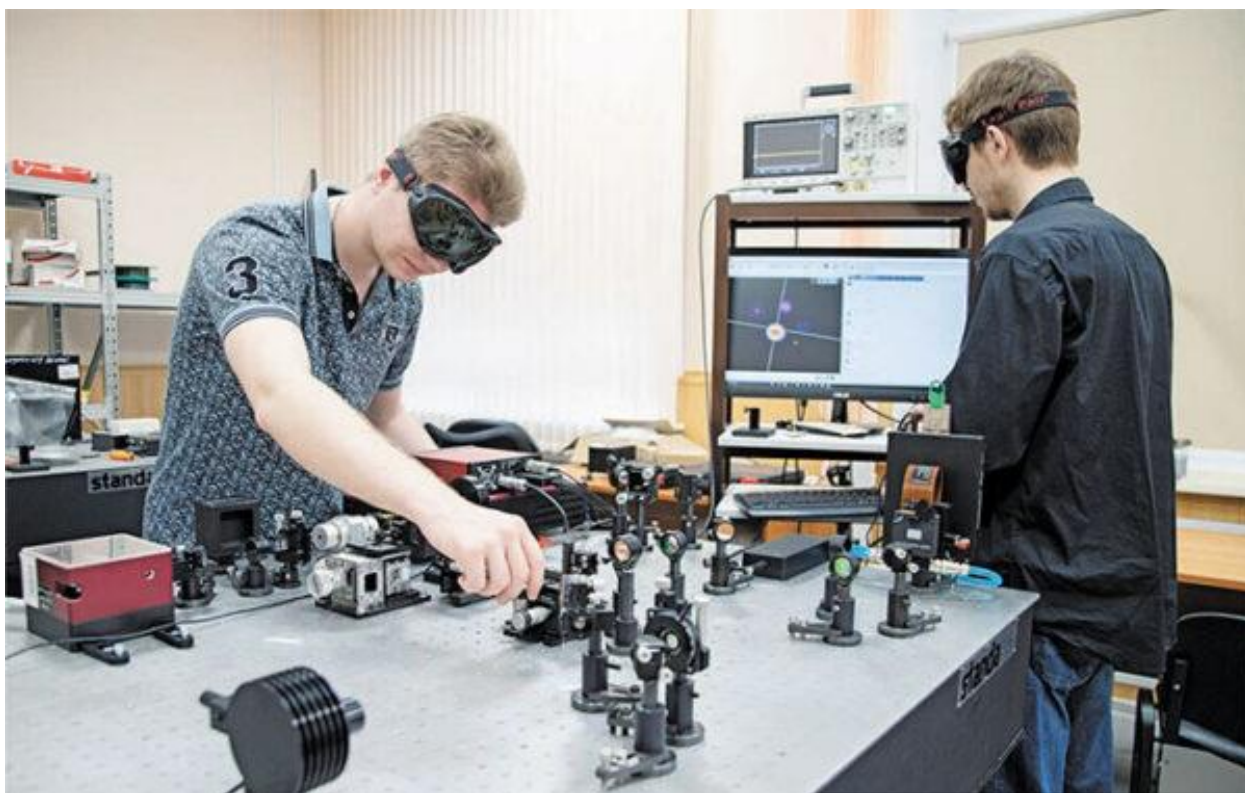
Студенты Никита Бочкарев и Саша Ревякин заводят структурированный пучок в 7-серцевинный световод
