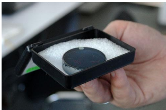
Пример полимерной плёнки на подложке для изучения нелинейно-оптического отклика
