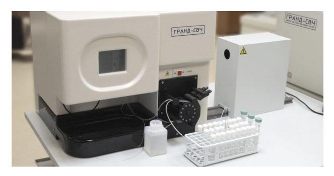
Учёные из Института автоматики и электрометрии СО РАН совместно с российской компанией «ВМК-Оптоэлектроника» разработали новый атомно-эмиссионный спектрометр параллельного действия с азотной микроволновой плазмой «ГРАНД-СВЧ» для элементного экспресс-анализа жидкостей.
