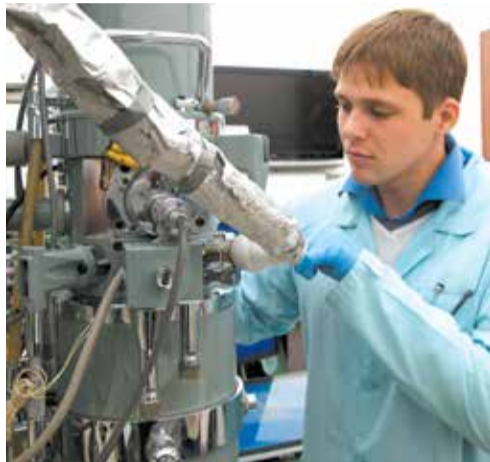
Эксперимент на электронном микроскопе со встроенной сверхвысоковакуумной камерой
