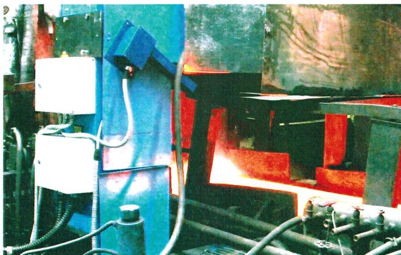
Рис. 6. Оптико-лазерная система регистрации толщины проката. Температура проката до 1200 °С, скорость проката до 30 м/с, погрешность менее 0.001 %.
