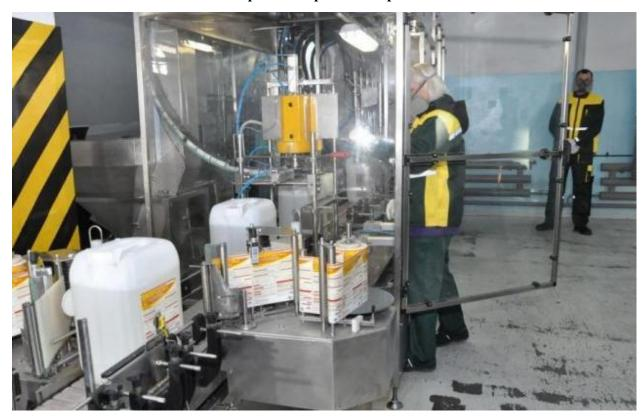
Сейчас на территории завода запущено производство глифосатсодержащих продуктов в небольшом цехе, управление всей запорной арматурой и механизмами осуществляется вручную, что приводит к участию в каждом цикле производства большого количества персонала.
